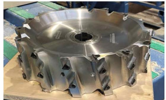
Wir arbeiten auf Hundegger-Anlagen (K2 Industry 1300) und haben diese mit speziell für BauBuche geeigneten diamantbesetzten Werkzeugen, Sägeblättern und großen Fräsaggregaten ausgestattet.
