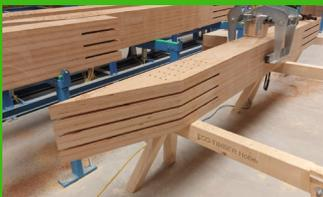
Abbund von BauBuche bis zu einem Querschnitt von 320 x 1300 mm
